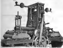
Vollgatter mit Walsenverschub, D. R. P. 17455. Maschine über 500 Sägespäner rollfrei.
