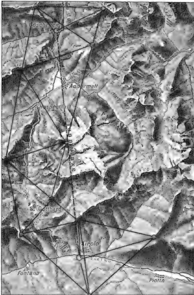
Der Gotthardtunnel. Triangulation von Gelpke.
