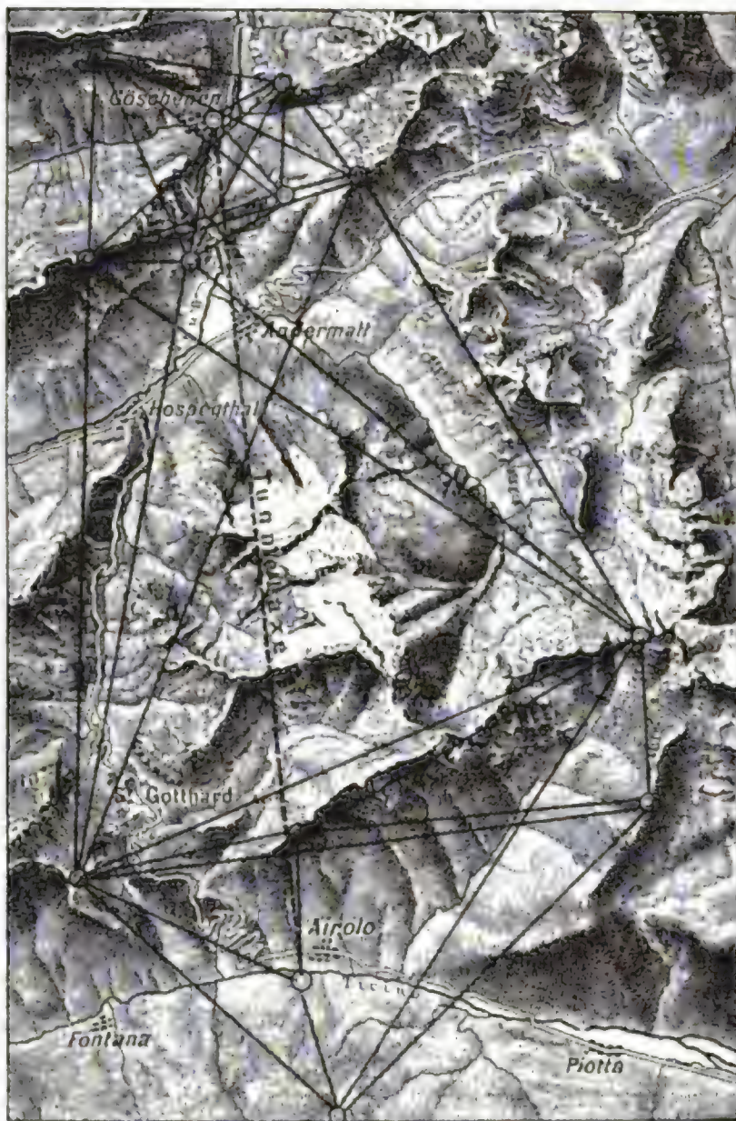
Der Gotthardtunnel. Triangulation von E. Koppé.
