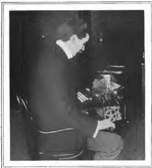
Donald Murray an der Übersetzmaschine seines Schnelltelegraphen.
