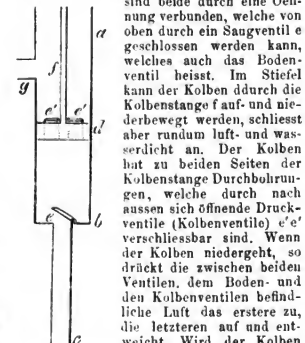
Fig. 1671. Saugpumpe in schematischer Darstellung.
