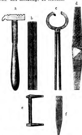
Fig. 1778. Beschlagwerkzeug. a Beschlaghammer, b Hauklinge, c Untersuchungs-zange, d Raspel, f Handstempel, e Nietmeißel.
