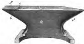
Fig. 1772. Ambos. a die Bahn, b das breite Endstück, c Rücken, d das Horn, e Ambosloch, f abgerundete Kante.
