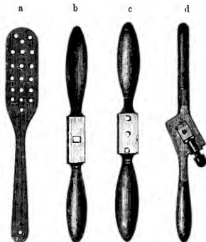
Fig. 1776. Werkzeug zur Fertigstellung der Eisen, a Platte zum Harten der Schraubstollen, b Wendeseisen, c Schneidseisen, d Schneidkluppe.
