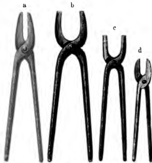
Fig. 1773. Zangen. a Feuerzange für Hufstäbe, b Feuerzange für Bauschen, c Bauschzange, d Handzange.
