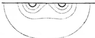
Denkt man sich Fig. 7 als Durchschnitt eines Rotationskörpers mit verticaler Rotationsaxe und berechnet für diesen Ring mit halbkreisförmigem Querschnitt in entsprechender Weise, wie unter 9), den Erdwiderstand, so findet man:
