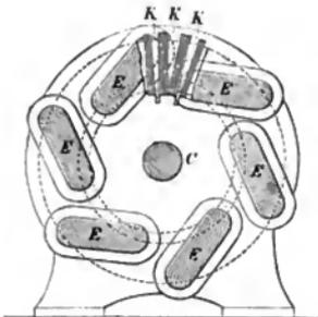
reicht, daß die Magnetkerne *E* (von länglichem Querschnitt) auf jeder Seite des Ankers so aufgestellt sind, daß die Pole derselben sich einander gegenüberstehen, wobei die Pole der auf jeder Seite befindlichen Magnetkerne sich gegenseitig überdecken.
