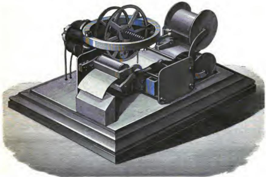
hebt oder senkt,  $\frac{1}{1000}$  Umdrehung machen. Ein an dem Rad angebrachter Zeiger würde also durch einen Umgang 1 m Schwimmerbewegung anzeigen.
