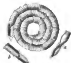
Fig. 155. Ofenkuppel aus Töpfen.
