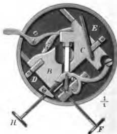
Trommel zum ABBE'schen Spektralokular.
