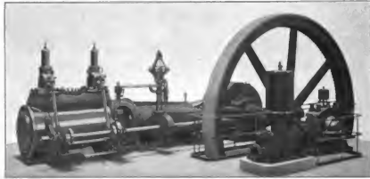
Fig. 36. 450 pferdige Abwärmekraftmaschine der Splanerei Steinen.
