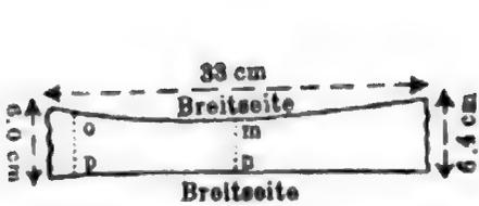
Fig. 2. Vertikaler Längsschnitt durch den Schleifstein
