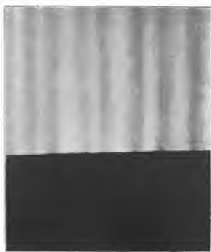
Fig. 3. Durch die Spaltblende projiziertes Bild, aufgenommen bei bewegtem Apparat und bei Stillstand des Quecksilbers. Der obere, belichtete Teil des Bildes erscheint wegen Ungleichmässigkeit des Lichtes streifig. Der untere Teil war durch das Quecksilber in der Röhre verdeckt und blieb daher unbelichtet. Geschwindigkeit des Spaltes 250 mm. Bogenlicht.
