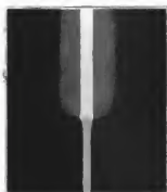
Fig. 2. Stark vergrößertes Bild des Kapillarelektrometers. Durch die Spaltblende sind die seitlichen Teile bis auf einen schmalen Streifen in der Mitte verdeckt.
