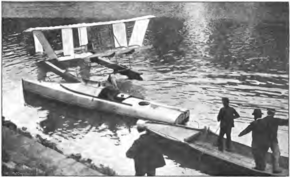
Fig. 11. — Blériots Flugapparat auf dem Wasser mit dem Motorboot von 100 Pferdestärken.
