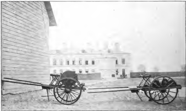
Abbildung 6. — Winde eines Feldluftschiffertrains des Ostibirischen Feldluftschiffer-Bataillons.
