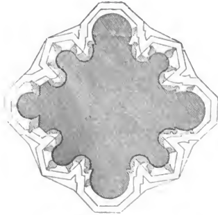
Grundriss eines Pfeilers.
