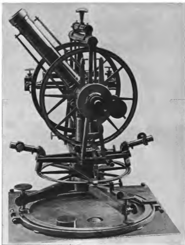
J. G. Repsold's Universal-Instrument, vollendet von A. u. G. Repsold, mitgetheilt von Herrn Friedr. Fischer, Leipzig.
