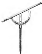
Cotes' Instrument für correspondirende Höhen, um 1720, nach Smith, Opticks.
