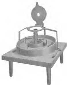
Kater's Vertical-Collimator, nach Phil. Trans. 1828.
