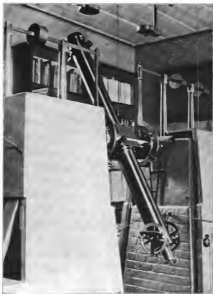
J. G. Repsold's Durchgangs-Instrument, 1829, mitgetheilt von Herrn Prof. Schorr.
