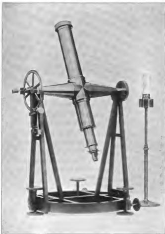
J. G. Repsold's kleines Durchgangs-Instrument, um 1818, mitgetheilt von Herrn General-Lieutenant Zachariae, Kopenhagen.
