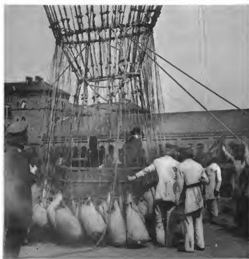
2. Befestigungsart der Ballastsäcke.
