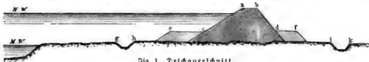
Fig. 1. Deichquerschnitt.
