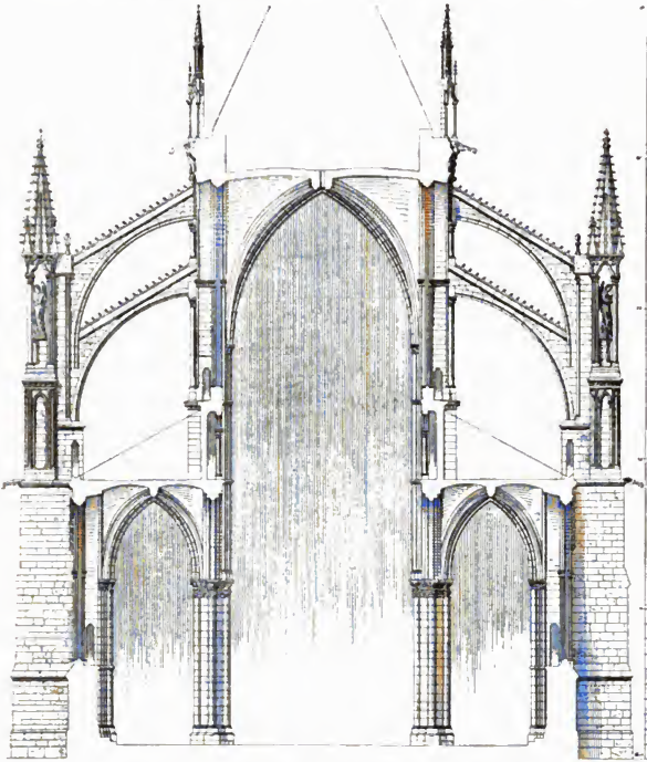
Fig. 5. Querschnitt der Kathedrale von Reims. (Nach Dehio und v. Bezold.)
