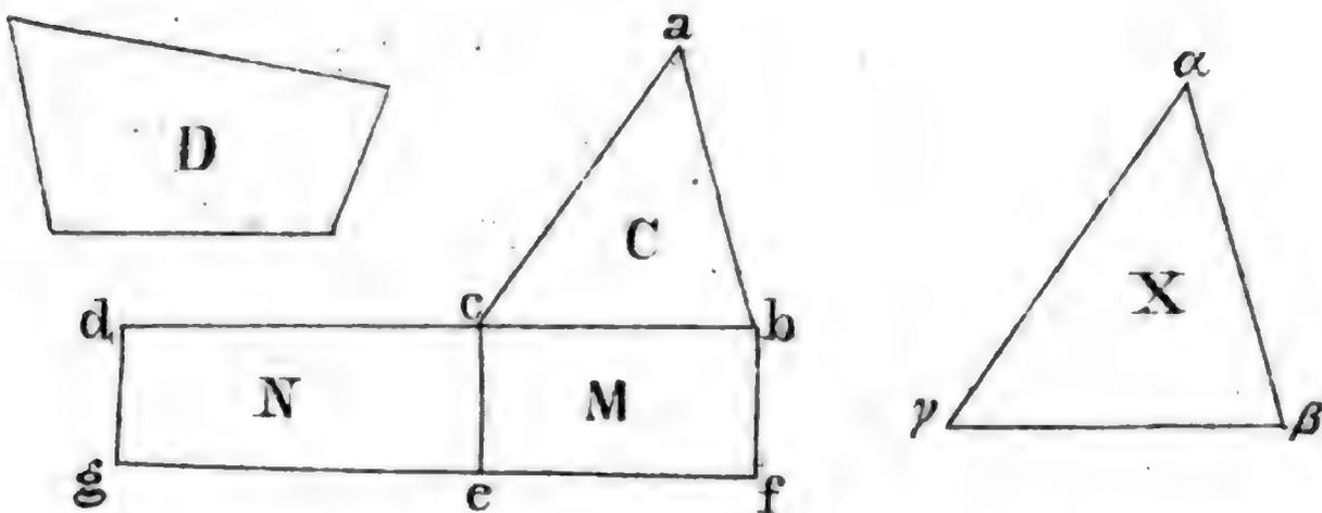
**Auflösung.** Ueber  $bc$  beschreibe ein Parallelogramm  $M = abc$  (I. 44.), und an  $ce$  setze ein Parallelogramm  $N = D$  unter den Winkel  $ecd = \sphericalangle fbc$  (I. 45.), so sind  $bc$  und  $cd$ , und eben so auch  $fe$  und  $eg$  in gerader Linie; zwischen  $bc$  und  $cd$  suche die mittlere Proportionale  $\beta\gamma$  (13.), und beschreibe über dieselbe eine, der  $abc = C$  ähnliche und ähnlich liegende Figur  $X$  (18.), so ist das Verlangte geschehen.
