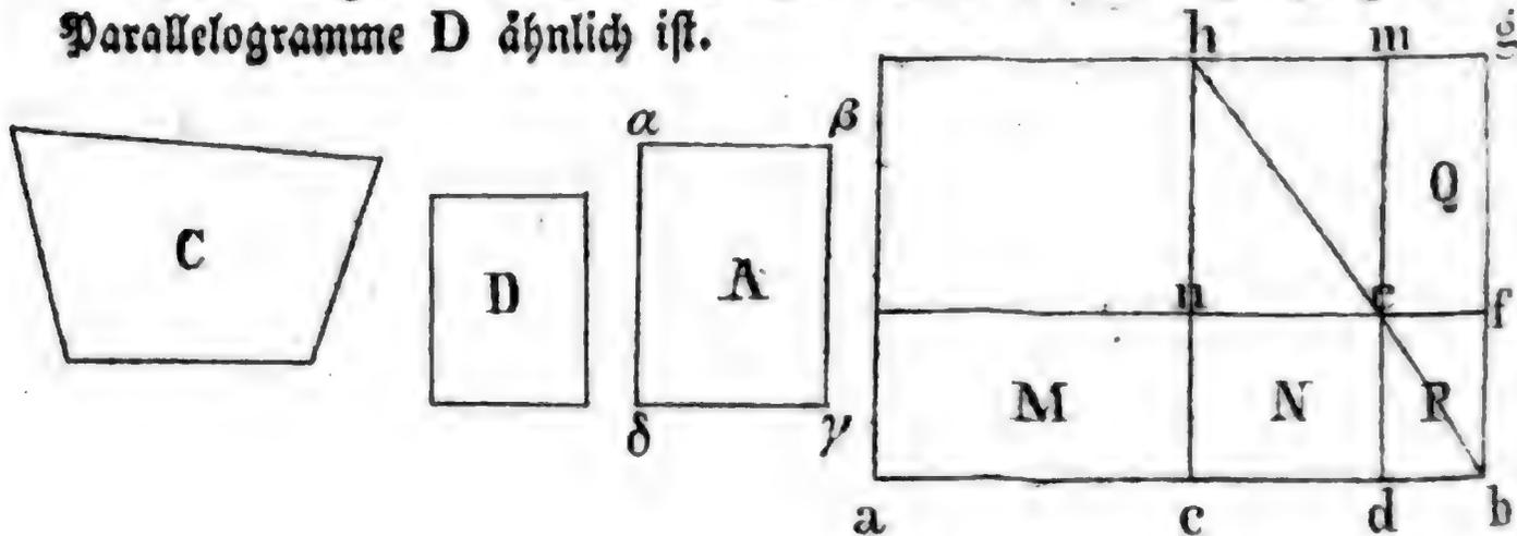
**Auflösung.** Es sey  $ab$  in  $c$  halbart; über  $cb$  beschreibe ein Parallelogramm  $cg \sim D$ , und vollende das Parallelogramm  $ah$ , so ist, nach der Voraussetzung,  $ah$  entweder der  $C$  gleich oder größer als  $C$ .
