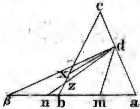
Aufgabe 618. Innerhalb eines Dreiecks ist ein Punkt  $d$  gegeben, und durch  $d$  mit einem Punkte des Umfanges verbunden; man soll von  $d$  aus die Linien  $dm$  und  $dn$  so ziehen, daß durch diese beiden Linien und die gegebene  $de$  das Dreieck in 3 Theile nach einem gegebenen Verhältnisse getheilt wird.
