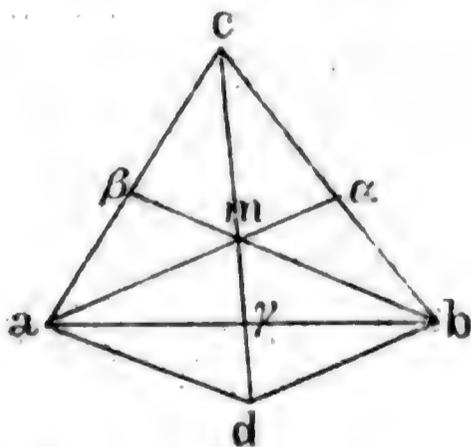
Lehrsatz 230. Sind in  $\triangle abc$  die Seiten  $cb$  und  $ca$  in  $\alpha$  und  $\beta$  nach demselben Verhältnisse geschnitten, und man zieht  $aa$ ,  $b\beta$ , und von  $c$  durch  $m$  die gerade Linie  $cm\gamma$ , so wird  $ab$  in  $\gamma$  halbart.
