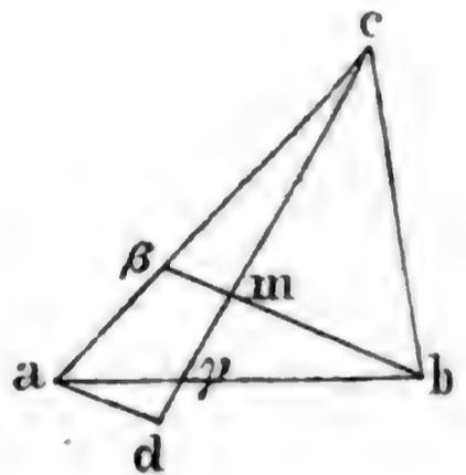
Lehrsatz 235. Ist  $c\beta$  das  $n$ fache von  $\beta a$  und  $b\gamma$  das eben so Vielfache von  $\gamma a$ , so ist  $cm$  von  $m\gamma$  das  $(n + 1)$ fache, und  $bm$  ist das eben so Vielfache von  $m\beta$ .
