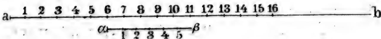
Ist  $ab$  ein Maasstab, auf welchem die Einheiten angegeben sind, und trägt man auf einer besondern Linie  $\alpha\beta$ , 5 dieser Einheiten auf und theilt diese in 6 gleiche Theile, ist also  $\alpha\beta = 5$  Einheiten und  $\alpha, 1 = 1, 2 = 2, 3 = 3, 4 = 4, 5 = 5 \beta = \frac{1}{6} \alpha\beta$ , so ist jeder Theil der Linie  $\alpha\beta = \frac{1}{6}$  der Einheit. Fällt also  $\alpha$  mit 6 des Maasstabes zusammen, so ist auf  $ab$  die Länge
