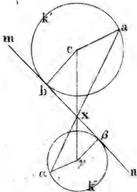
Da nun  $cb = ca$ , so ist auch  $\gamma\beta = \gamma\alpha$ , also  $\gamma\beta$  ein Radius des Kreises  $k''$ , und da  $\gamma\beta$  normal auf  $xn$  steht, so ist  $xn$  Tangente dieses Kreises.
