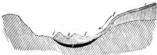
Querschnitt durch das Bett des Simeto, welches durch einen Lavaström abgedämmt wurde. — l das frühere Bett des Simeto; l der Lavaström; s das neue Bett, welches der Simeto durch die Lava gewaschen hat.
