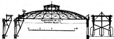
Abb. 519. Kuppeldach über einem Gasbehältergebäude in der Holzmarktstraße.
