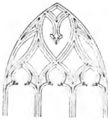
Fig. 154. Melnik. Probststeinkirche. Das Masswerk im polygonalen Abschlusse des Presbyteriums.
