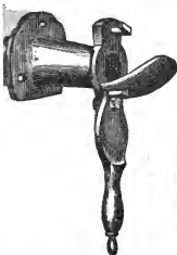
Fig. 11. Jaucheverteiler von H. Maysarth u. Co. Frankfurt a. M., zum Anschrauben an den Boden des Jauchefasses. Durchgangsöffnung 50 u. 60 mm. Preis 6 resp. 7 Mk.
