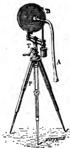
Akustischer Apparat, der im Nebel fahrenden Schiffen die Annäherung eines anderen Schiffes anzeigt.
