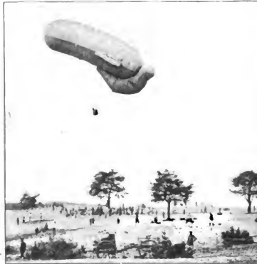
Die Einholung des Ballons auf hügeligem Terrain, wobei das Haltekabel vom Wagen aus um Bäume gezogen wird.
