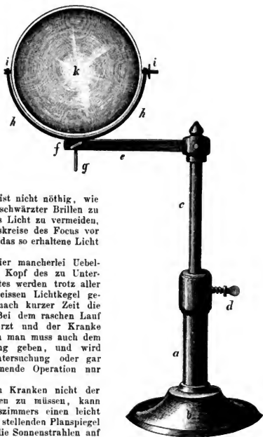
Voltolini's Hohlspiegel zur Untersuchung bei Sonnenlicht.
