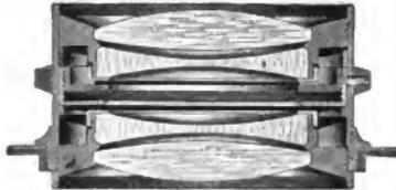
Die Hinterlinse allein kann mit kleineren Blenden als selbständiges Objektiv von nahezu der doppelten Brennweite des ganzen Systems benutzt werden.
