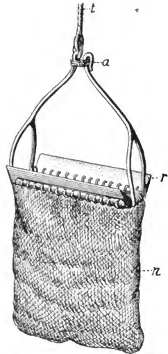
Fig. 616. Dredsche n. WHYVILLE THOMSEN. (CHALLENGER.) r Rahmen, n Netz, t Tau zum Aufholen usw., a Strick, dazu bestimmt, beim »Festkommen« des Netzes zu reißen.
