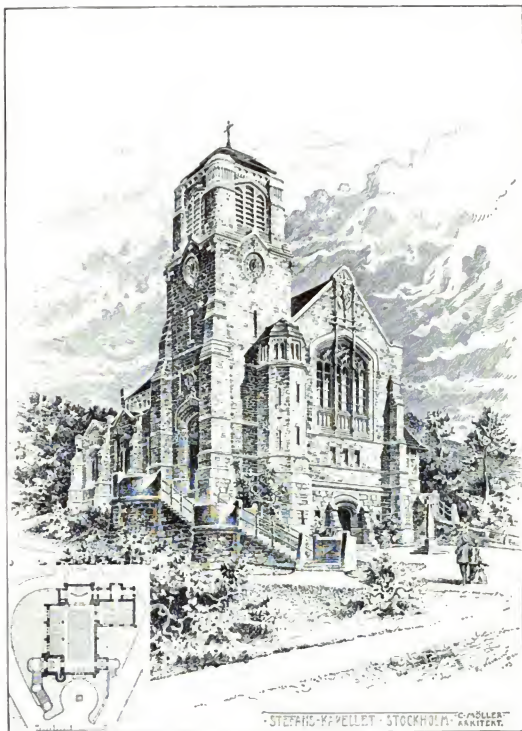
Fig. 79. Die Stephans-Kapelle in Stockholm. Mauerflächen in roh behauenen Kalkstein. Leisten etc. in fein behauenen Kalkstein, die Soubassementpartie in Granit. Bedachung: Schiefer und Kupfer. Das Interieur mit verputzten gelbweissen Mauerflächen und grünlasierter Holzdeck-Konstruktion.
