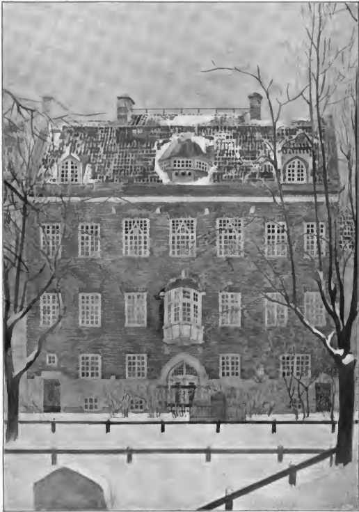
Fig. 111. Gebäude der Ärztlichen Gesellschaft in Stockholm. Die Fassade in Hand-geschlagenem rotem Ziegelstein und graugelbem Granit. Bedachung in rot-braunen Ziegeln und Kupfer.
