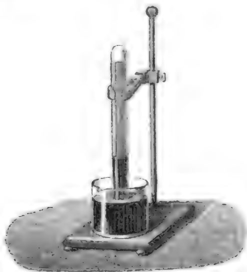
Apparat zur Trennung des Stickstoffes vom Sauerstoff.
