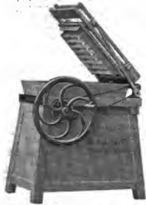
Dr. E. Alberts Aetzstriegel in geöffnetem Zustande.
