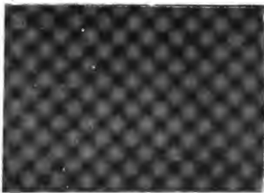
Fig. 2 Zwei übereinander gedruckte Punktnetze (150 Punkte pro Zoll), Winkelung 2^\circ .
