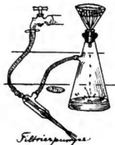
Leitungswasser fließt in solchem Masse durch die enge Innenführung, dass dieselbe gerade alles aufnehmen und abführen kann und
