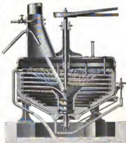
Fig. 7. Hentschels Apparat (Durchschnitt).
