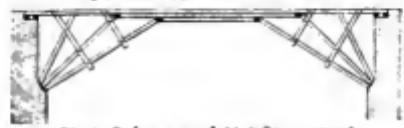
Fig. 4. Zusammengesetztes Sprengwert.
