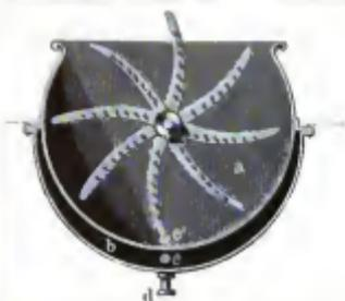
Fig. 1. Lachsbräu Maischapparat (Querschnitt).
