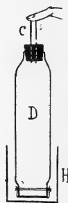
FIG. 2. — Tube filtre manié comme une pipette, placé dans le vase H contenant le réactif fixateur.
