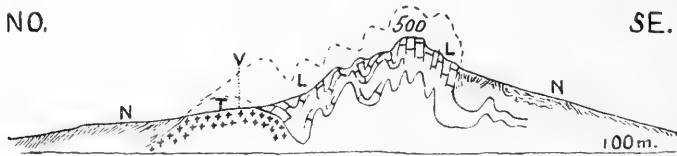
Fig. 5. — COUPE SCHÉMATIQUE A TRAVERS L'EXTRÉMITÉ DU DJEBEL RESSAY. 1/25000. T, Trias; L, Lias et Tithonique non séparés; N, Néocomien. Le point marqué V est l'emplacement du village de la Société minière.
