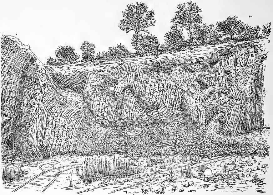
Fig. 35. — CARRIÈRE DE LA ROUSSIÈRE (ST-GERMAIN-LE-FOUILLOUX). Vue du front de taille situé à l'Ouest. Les bancs sont affectés par des plis dont la régularité est interrompue par des failles. L'inclinaison générale des couches est au Sud (octobre 1910).
