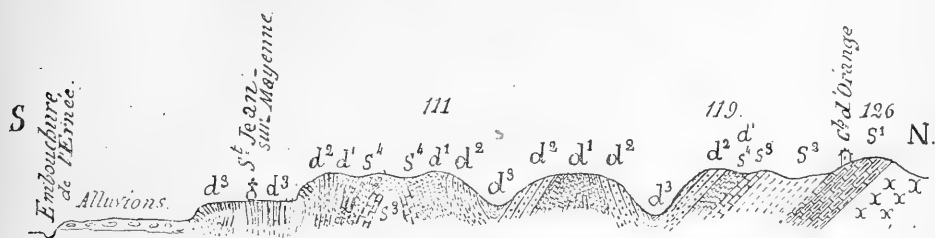
Fig. 34. — Coupe montrant le DÉVERSEMENT DES BANCs DANS LE BOURG DE ST-JEAN-SUR-MAYENNE, au voisinage de la vallée de l'Ernée, et le mode de plissement des différentes assises dévoniennes et siluriennes, jusqu'aux schistes précambriens. — Long. : 1/37500. Même légende que celle de la figure 32.
