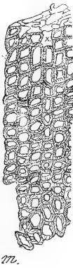
Fig. 10. — Bord droit de la rupture. Tissu ligneux encore intact. Il n'y a qu'une seule cellule qui commence le travail disloquant. C'est :
