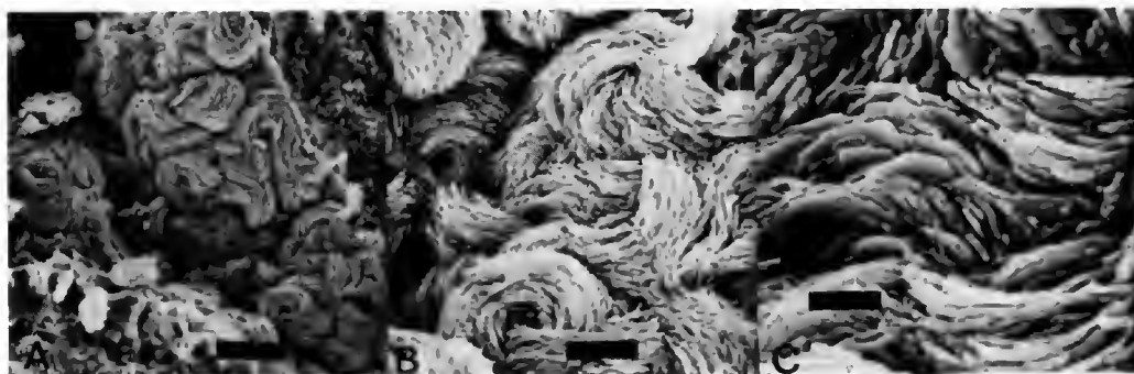
FIG. 3. — Agrégats de lithiophorite. Observation en microscopie électronique à balayage. A : tiret = 10 \mu m ; B : tiret = 3 \mu m ; C : tiret = 0,5 \mu m .
