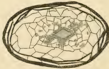
Fig. 3. Une oolite de Zdice composée du quartz secondaire (blanc), de la sidérose (un individu cristallin au centre et un agrégat grénu, gris) et de la limonite (noir). Dessiné entre des nicols croisés. (Aggr. 38×.)
