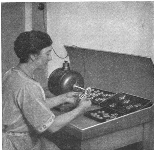
11. Elektrisch getriebene Polier- und Schleifmaschine für das Eisene Kreuz.
