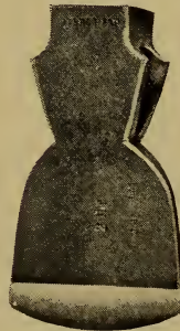
Fig. 94.—Kent Axe Head.
