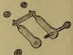
Fig. 459.—Heel Strap and Bolt.
