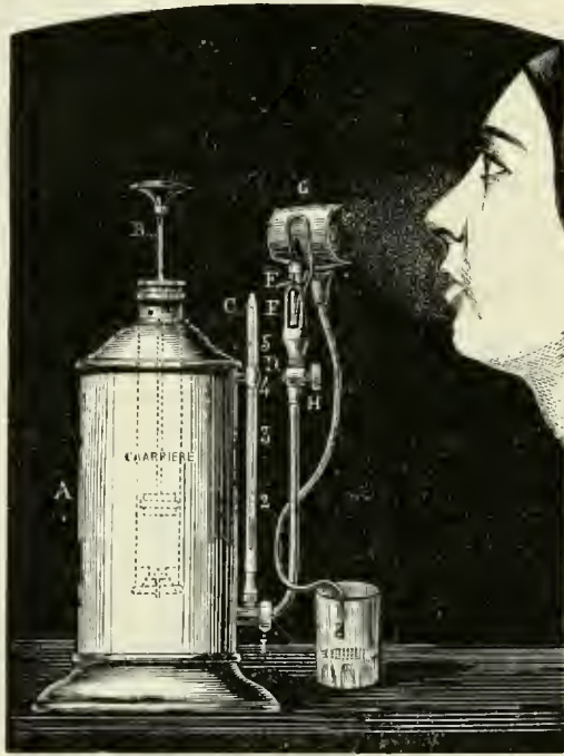
A. Vase contenant le liquide à pulvériser. — B. Piston de la pompe produisant la compression du liquide. — C. Manomètre pour indiquer le degré de cette compression. — D. Le degré 4, qu'on ne faut jamais dépasser. — EF. Clef du filet d'eau capillaire. — G. Le tambour qui dirige la poussière liquide vers la bouche du malade. — H. Robinet qui donne passage au liquide à pulvériser. — I. Vis qui joint la branche IHF au corps de l'appareil, et ouverture par où on met le liquide dans le vase. — 2, 3, 4, 5, chiffres qui marquent la pression du liquide en atmosphères (modèle Charrière).
