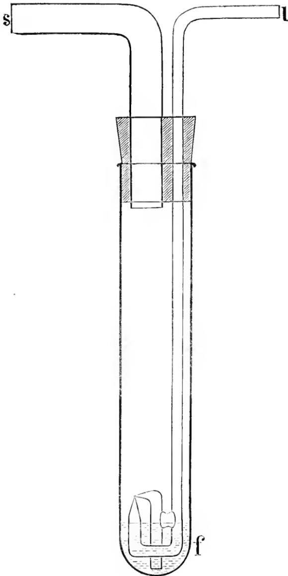
Die bakterienhaltige Flüssigkeit befindet sich bei f, bei l wird mittelst eines Handballons Luft eingeblasen, dann entweicht bei s der feine, bakterienhaltige Nebel, der direkt in den Athemraum der Versuchsthiere geleitet wird. Wie in den erwähnten „Untersuchungen“ dargelegt ist, besteht der Vortheil dieses „indirekten“ Sprühnebels gegenüber dem in gewöhnlicher Weise erzeugten darin, dass alle gröberen Wassertröpfchen in dem Apparate zurückbleiben
