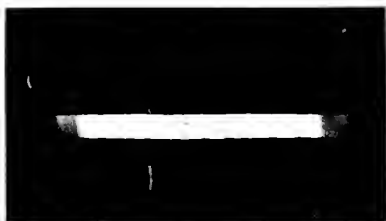
Fig. 8. Beugung des von einem Spalt ausgehenden parallelen Lichtes durch ein Glasgitter bei senkrechtem Einfall.
