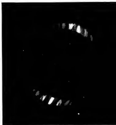
Fig. 11—12. Wie Fig. 8 bei einem Einfallswinkel von ca. 85^\circ . Außer der Beugung des durchgehenden Lichtes (D) zeigt sich auch die Beugung des reflektierten Lichtes (R).
