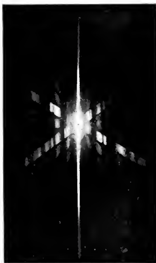
Fig. 21. Beugungserscheinung durch drei unter 60^\circ gekreuzte Gitter bei senkrecht einfallendem Licht.
