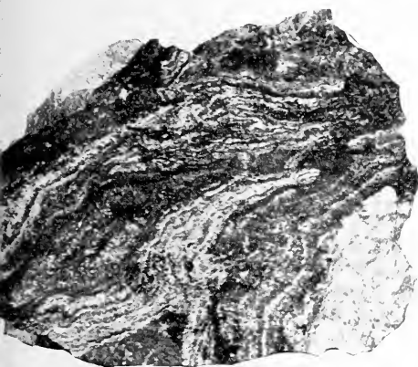
6. Fluidalstruktur von Arsenerz, Serpentin und Salit. \frac{1}{4} der nat. Größe.
