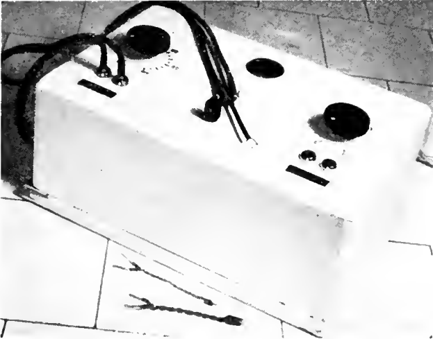
Fig. 55. — Rezistența reglabilă și cautererele.
