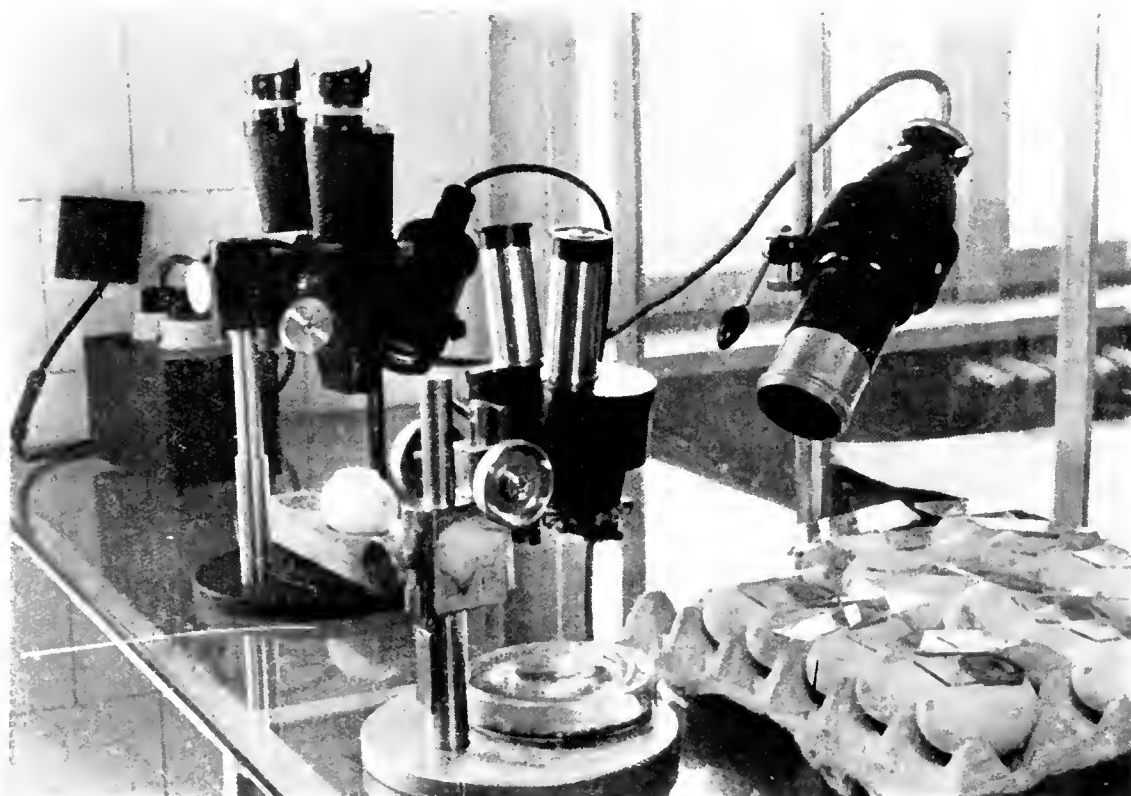
Fig. 80. -- Așezarea celor două lupe binoculare pentru executarea transplanțării embrionare.
