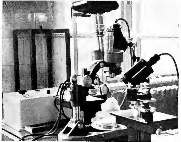
Fig. 60. — Dispozitiv de operație și electrocauterizare. Instrumentele sînt montate pe brațele micro-manipulatorului. Camera fotografică pe unul din ocularele binocularului. Iluminație laterală.
