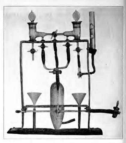
Fig. 1.—The Biometer. One-fourth actual size
