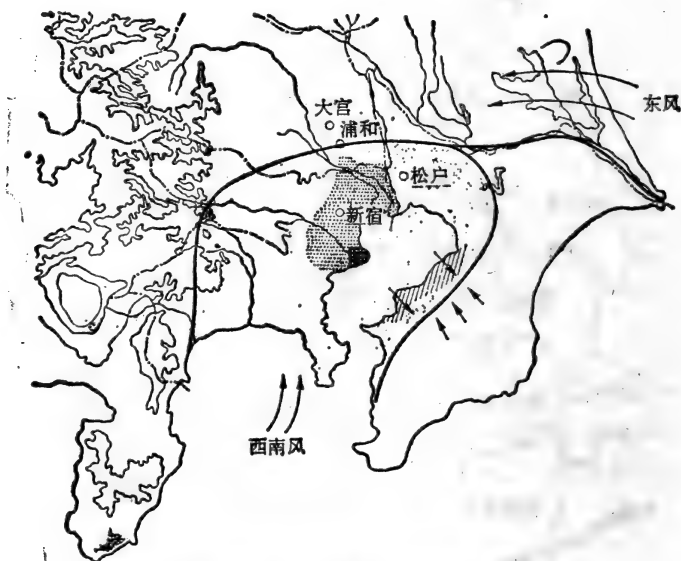
图 2.12 封闭式构造下(大气的最大混合层高度 1000 米)的东京湾海陆风系区域(灰色表示划分的地区)和超过生物耐性限度指标的地区(印点的地区)(科学技术厅, 1972) (大气最大混合层高度在 1000 米以下的关东以及福岛县的范围和封闭式构造下被东风及千叶县东南风所缩小的海陆风系区域)
