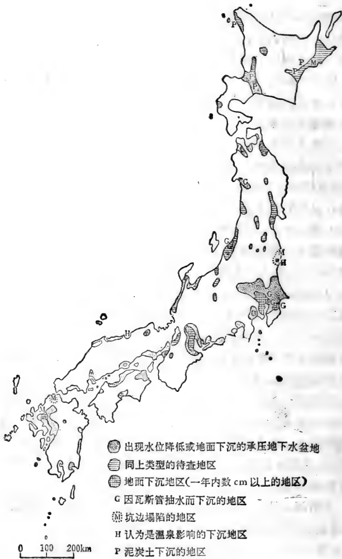
图 2.1 日本地面下沉区域
