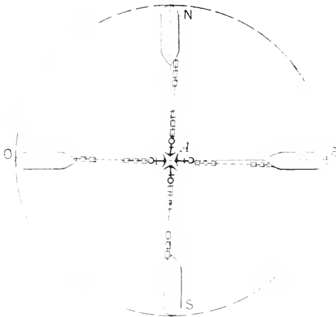
Fig 1. Mouillage sur une seule ancre.
