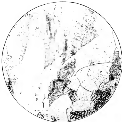
Fig. 38.—Original. 1496-30. 500 \times . Etchant 4 per cent nital.
