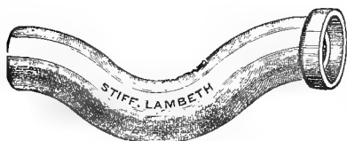
Fig. 161.—A Simple Syphon.
