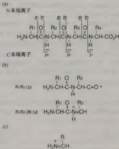
图 5.4 常见的带正电荷的碎片离子命名 (a) N 末端和 C 末端离子; (b) 中间酰基离子 (internal acyl ions); (c) 中间亚氮离子 (internal immonium ions)。
