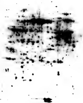
图 15.1 拟南芥叶蛋白的 2-DE 胶 一维在 pH3.5 到 10 非线性梯度的 IPG 胶条中; 二维 SDS 胶为丙烯酰胺/PDA 均匀胶, 12% T; 蛋白点用银染方法染色。
